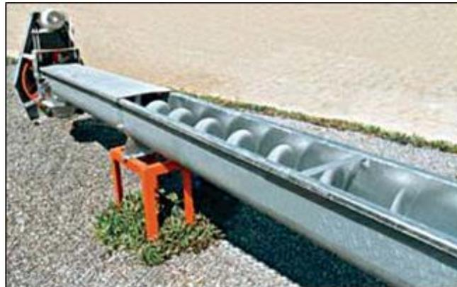
**Figura 6:** Transportador helicoidal
