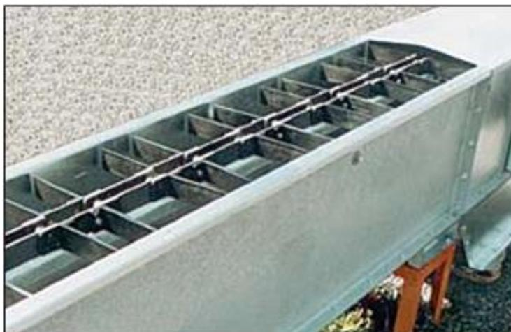
**Figura 4:** Transportador de corrente
